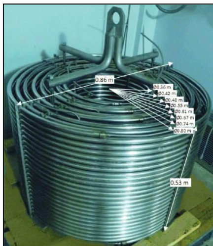
Рисунок 10 – Реактор непрерывного действия объемом 73 литра [54]
